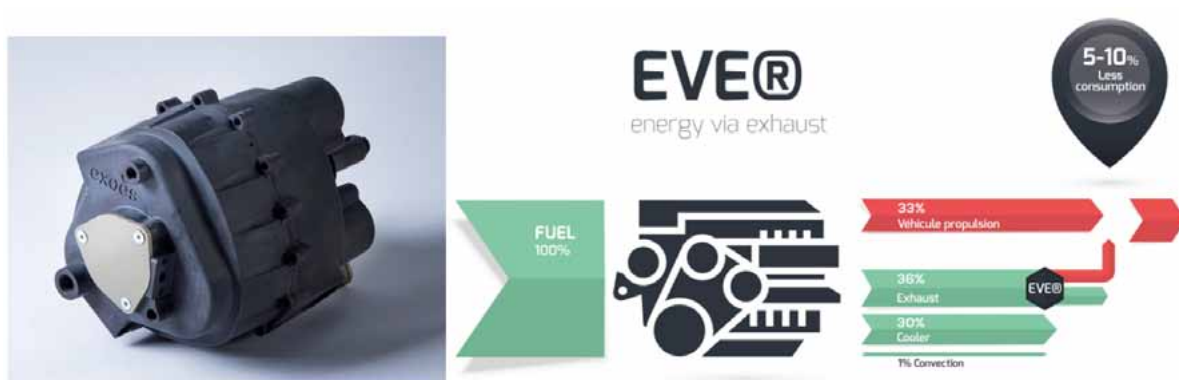
Bild 8: Rekuperationseinheit und die in der Fahrerprobung erzielten Minderungen im Kraftstoffverbrauch (Foto: EXOÉS)
