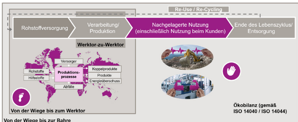
Bild 10: Die Bewertung des gesamten Lebenszyklus bietet eine ganzheitliche Sicht auf die Emissionen [104]
